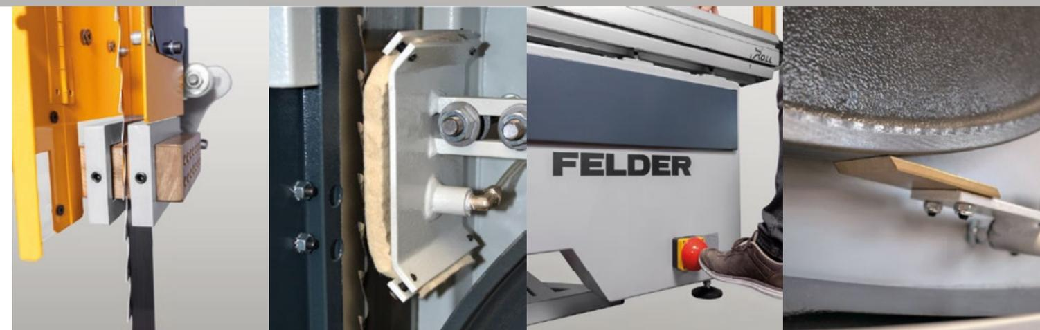
Guidage de scie à ruban avec des éléments en bronze (en option)
