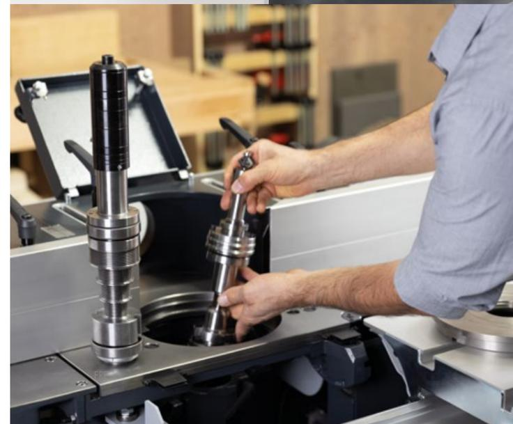
Avec le dispositif de basculement Felder, l'entraîneur reste toujours sur la machine et peut être utilisé à tout moment sans problème.
