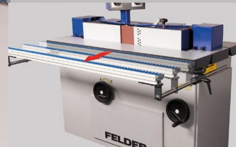
La table de ponçage peut être inclinée en continu entre 90° et 45°, ce qui permet d'effectuer des ponçages d'angles.
