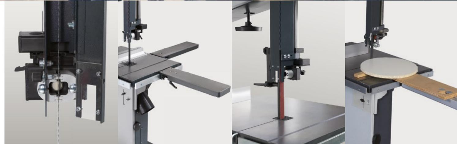
Le guidage de scie à ruban X-Life® avec insert céramique vous garantit d'excellents résultats de coupe et une stabilité maximale de la lame grâce à quatre blocs de guidage directement en contact avec la lame de scie.
